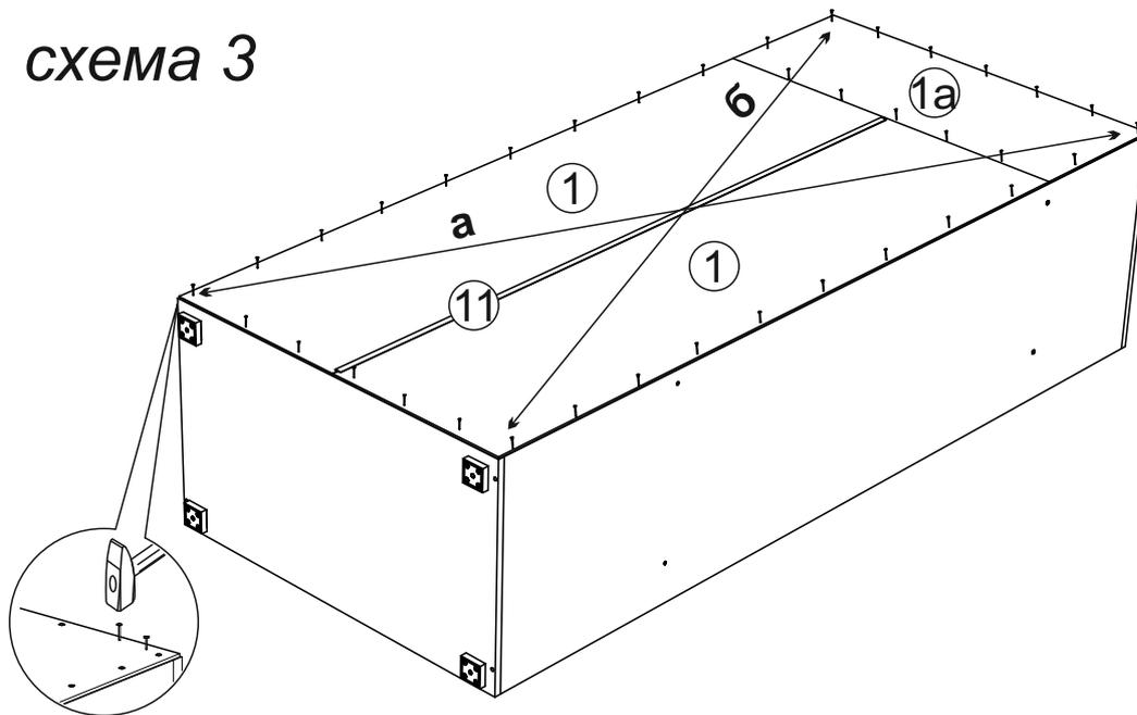
5. Установите шкаф на место. Закрепите петли на створках. Створки №9 и 310 прикрепите к боковинам при помощи шурупов 4x16. Зазоры отрегулируйте по схеме приведенной выше. Установите штангу на штангодержатели в зависимости от компоновки шкафа, как показано на схеме 4.
